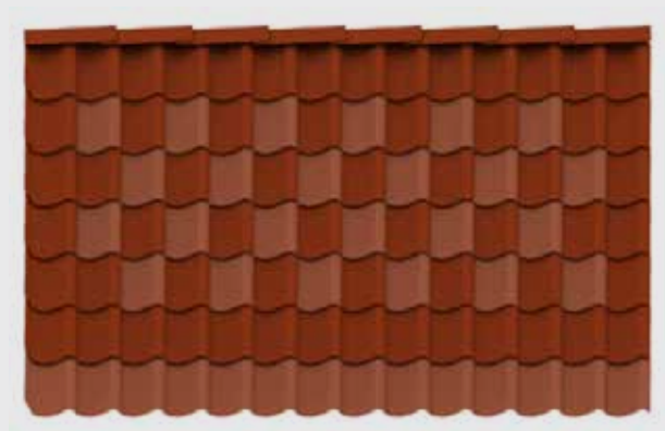
Hver anden tagsten bindes (mørke sten). De bundne sten fordeles diagonalt på tagfladen
